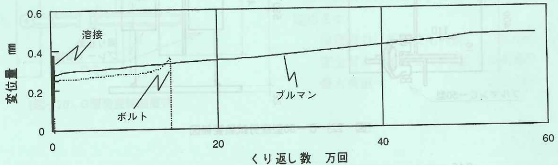
〔図-25〕接合法別比較疲労試験回数-変位量グラフ
